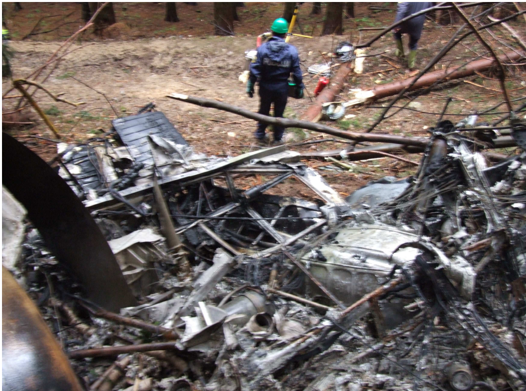
Slika 4: Skoncentriranost razbitin na mestu nesreče z vidnim ukrivljenim krakom propelerja motorja
