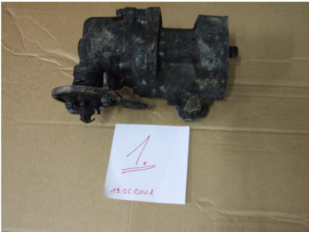
Slika 4: Regulator števila vrtljajev propelerja je bil v položaju za križarjenje
