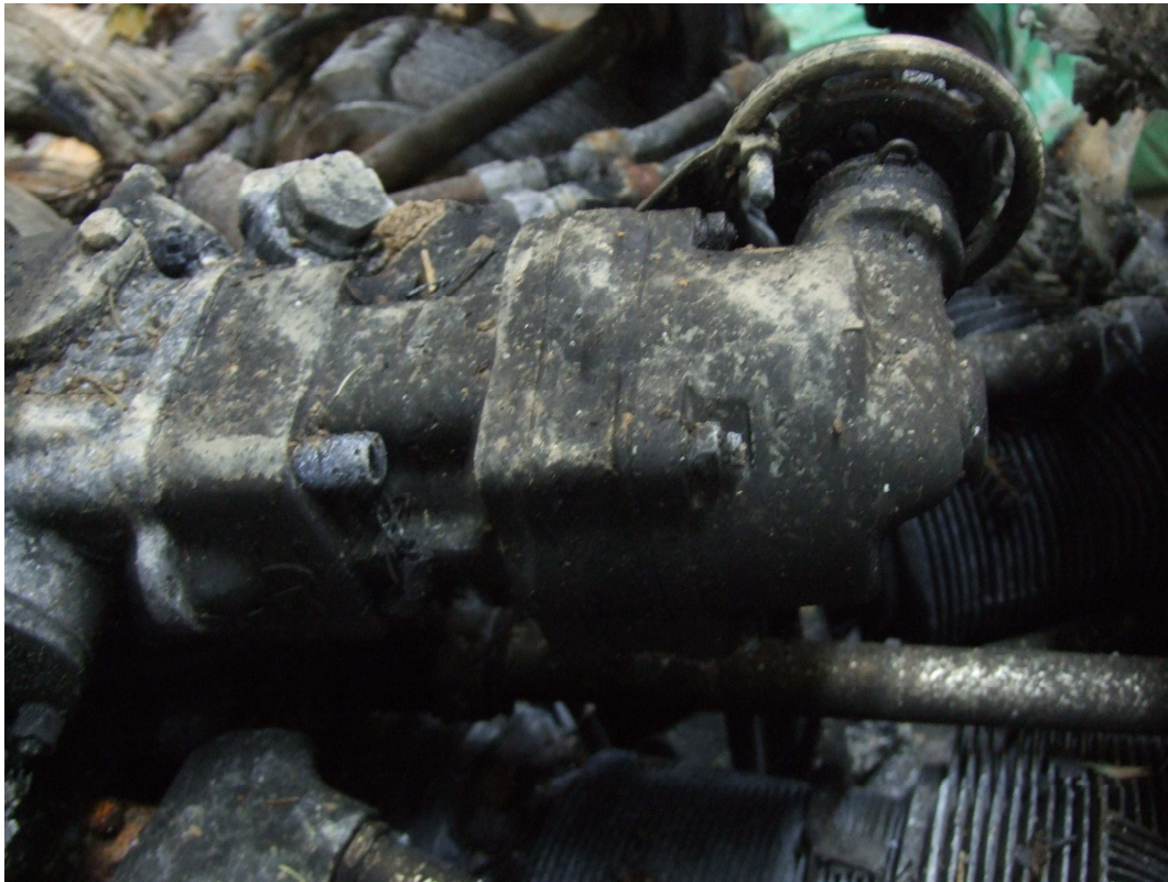
Slika 3: Regulator števila vrtljajev propelerja (ang. Speed Governor)
